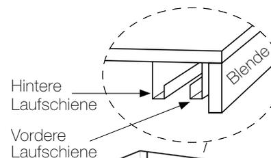
1. Hängen Sie die mittlere Türe (10) in die vordere Laufschiene der Deckplatte ein. Anschließend heben Sie die Türe in der Laufschiene an und platzieren die Bodenführung der Türe in der vorderen Führungsschiene der Bodenplatte.
